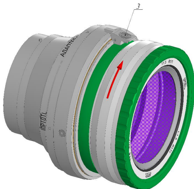
Рисунок 7. Фиксация адаптера и насадки
