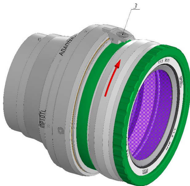
Рисунок 2. Фиксация адаптера и насадки
